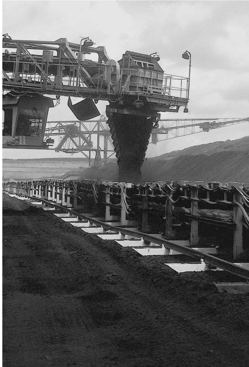
Abb. 33: Kohleförderband im Tagebau Welzow Süd
