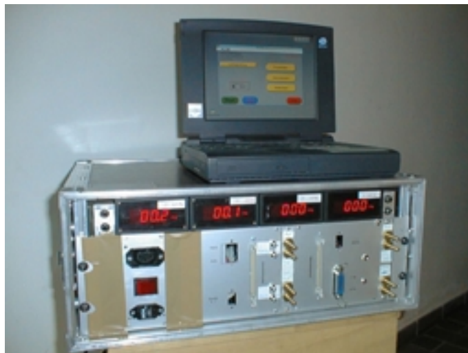
Bild 15: Rechnergesteuertes Meßwernerfassungs- und Regelsystem für Blower Door-Messungen. Weiterentwicklung des in [2] beschriebenen Meßsystems.
