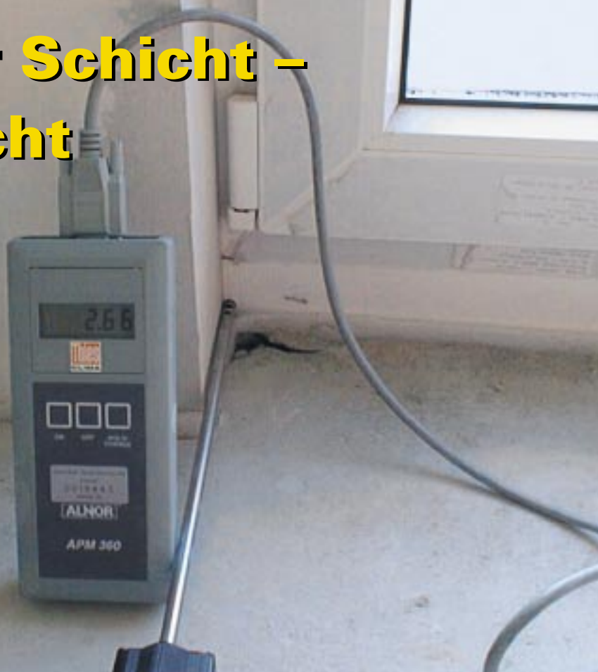
Das Messgerät zeigt es an: Leckage im Bereich des Randdämmstreifens
