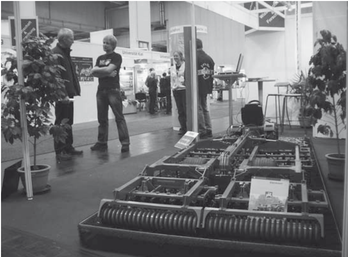
Mit Hilfe eines Sensors bearbeitet das Gerät den Boden in Abhängigkeit zur Mulchauflage und wirkt so der Erosion von Ackerflächen entgegen. Foto: FB 11
