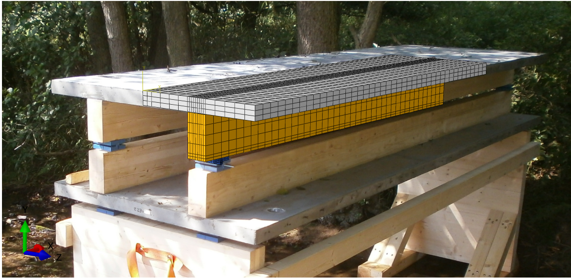
Abbildung 5.1: Finite-Elemente-Netz für die numerischen Berechnungen
