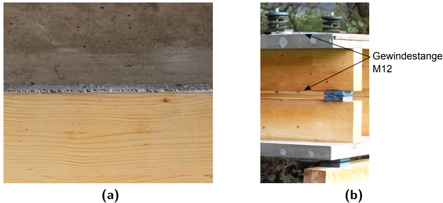
Abbildung 3.37: Bauteil E 2.1 (a) Delamination im Bereich der Klebfuge zum Holzträger (b) Sicherung mit Gewindestange im Auflagerbereich
