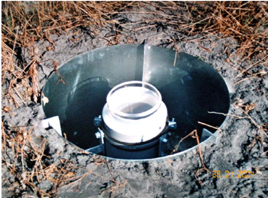
Abb. 111: Bodenebener Niederschlagssammler mit einer Auffangfläche von 200 cm 2
