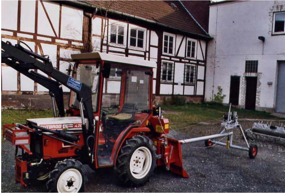
Abb. 9: Allradschlepper, Forstseilwinde, Umlenkwagen und Haldenigel
