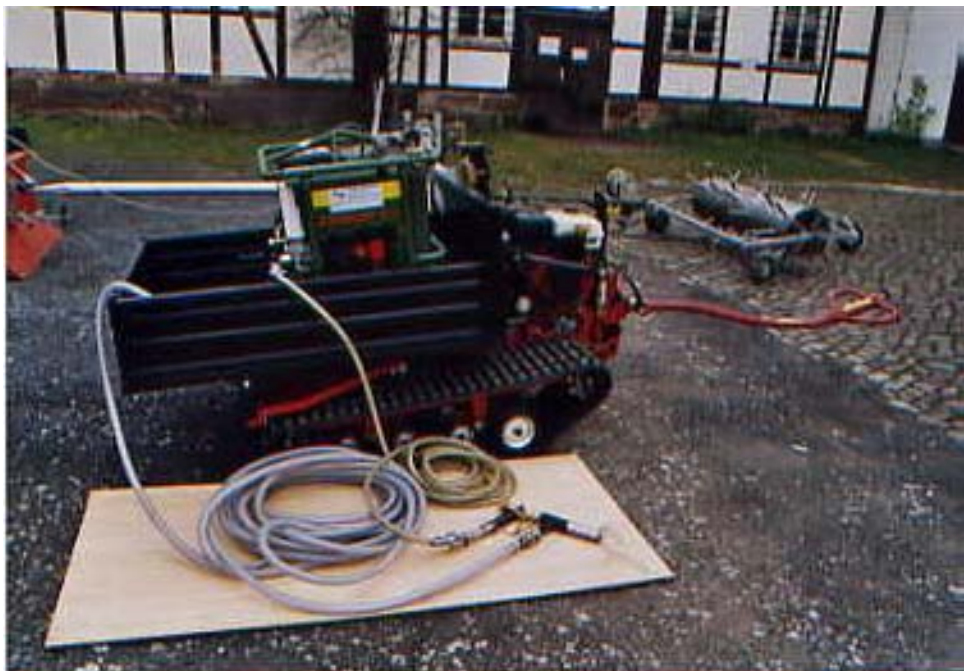
Abb. 7: Kompressionstechnik – Kompressor, Sprühpistole und Raupenfahrzeug
