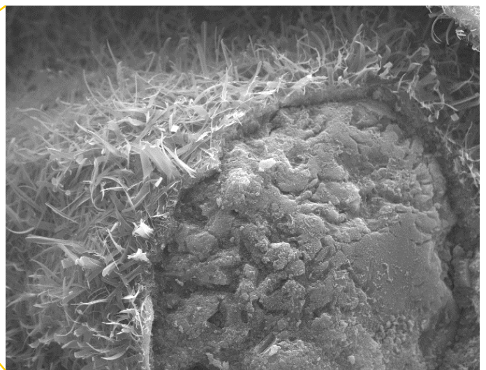
Bild 10.7-f: Serie 49: KS-Probe mit Feinsand Nullserie ohne Fließmittel Detailausschnitt- Bildbreite 145 µm
