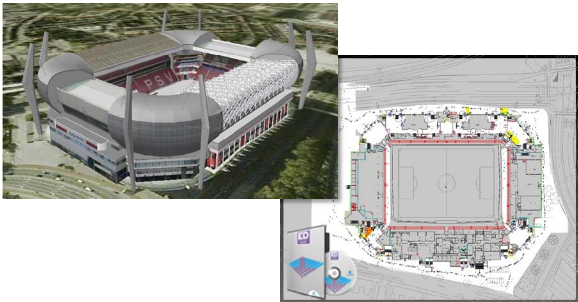
Bild 2.6: Enterprise Dynamics Simulationsmodell für die Simulation von Personenströmen in einem Fußballstadion; links: 3D Visualisierung des Simulationsmodells
