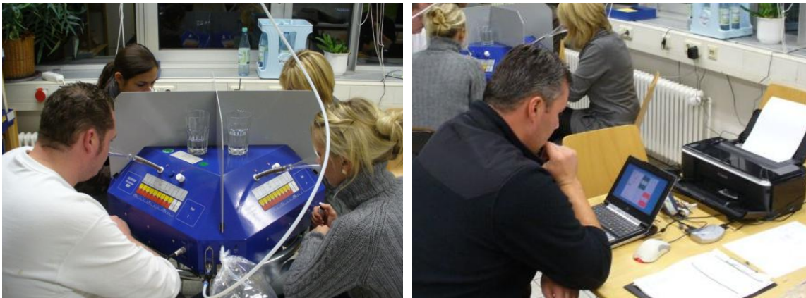
Abbildung 13: Durchführung von olfaktometrischen Messungen mit dem Ecoma TO-9 mit Prüfern (links) und Versuchsleiter (rechts)
