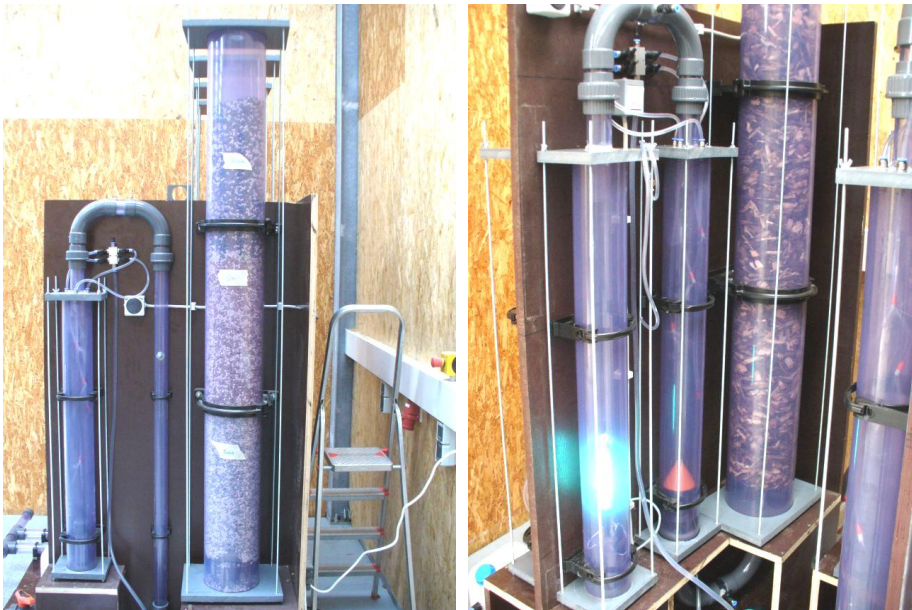
Abbildung 27: TKS, links: Befeuchter im Gegenstrombetrieb; rechts: Befeuchter im Gleichstrombetrieb, Filter wurden grundsätzlich aufwärts durchströmt
