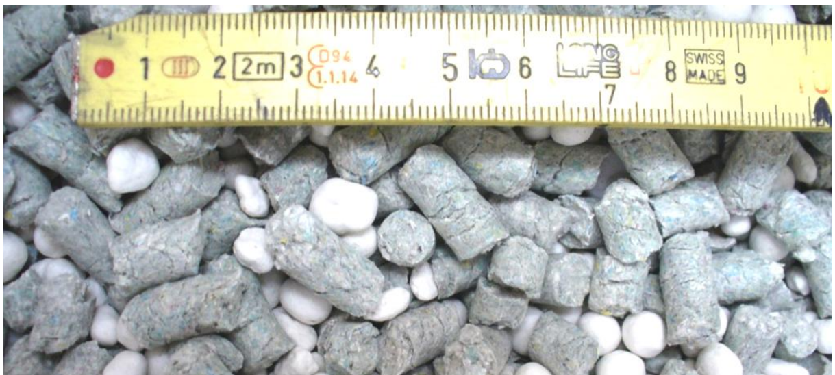
Abbildung 32: TKS, UGN Aktivgranulat, mit Glasschaumkugeln gemischt
