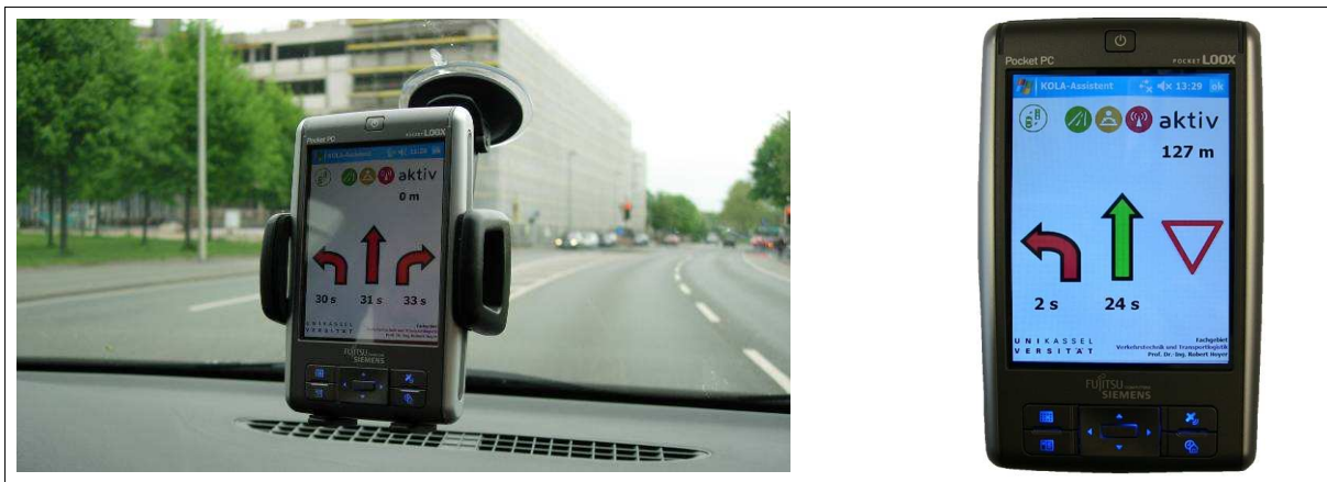
Abbildung 4-1: Restzeitinformation auf mobilem Endgerät
