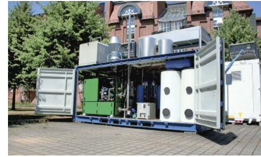
Karft-Wärme-(Kälte)-Kopplung (KW(K)K)- Modellanlage des Fachgebiets upp an der Universität Kassel
