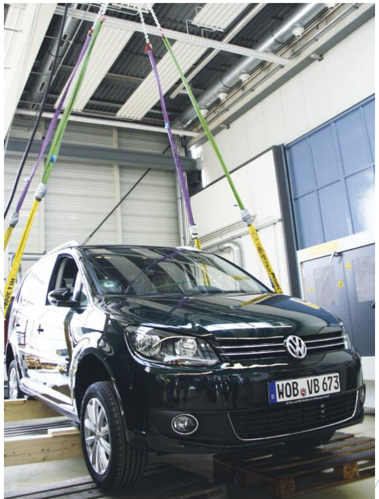
Kleblabor: Fahrzeug, das mittels Klebung an einem Kran hängt, Campusfest 2011
