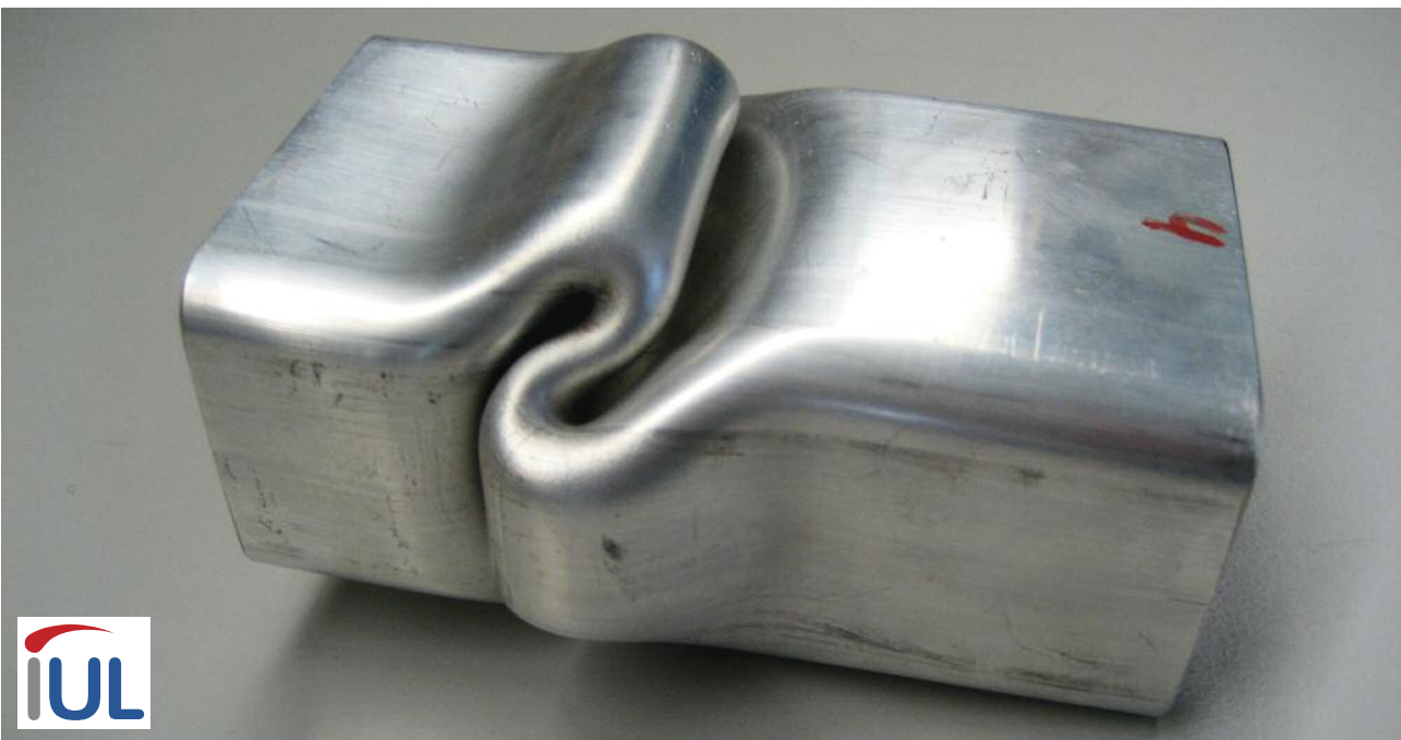
Mikrostrukturell gradierte Crashbox mit gezieltem Versagensverhalten
