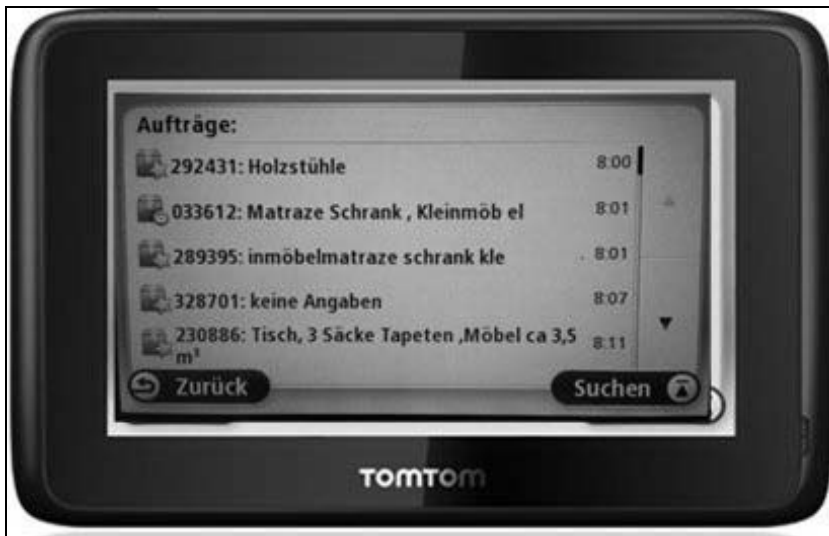
Abbildung 3: Anzeige der Aufträge in Abfahrreihenfolge auf dem Telematikgerät im Fahrzeug
