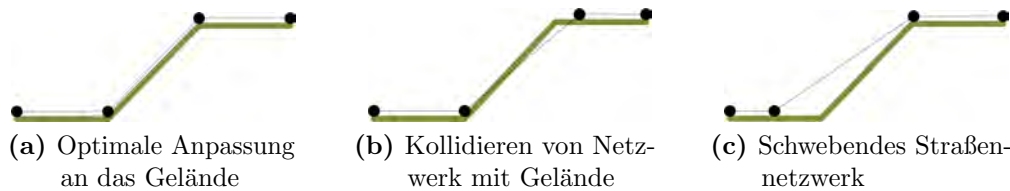
Abbildung 88: Anpassung des Straßennetzes an das Geländemodell
