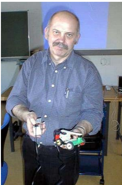
Unprogrammiertes Fahrzeug. Steuerung mittels einer Batteriebox mit An/Aus Schalter.
