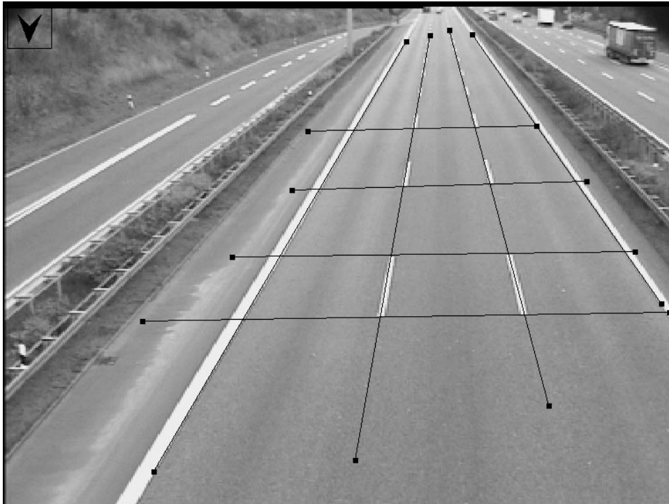
Abb. 4-16 Kalibrierungsraster aus Fahrbahnmarkierungen
