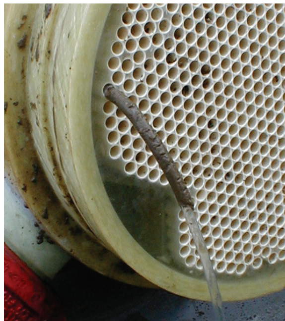
Abbildung 39: verstopftes Rohrmodul vor chemischer Reinigung
