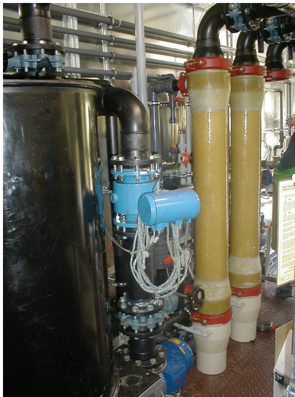
Abbildung 24: Rohrmodule im Einbauzustand
