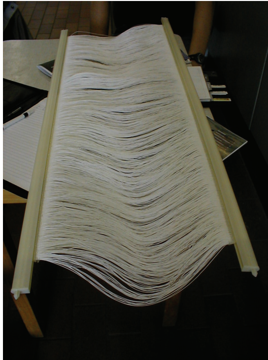
Abbildung 26: Einzelement eines Hohlfasermembranmoduls der Fa. Mitsubishi
