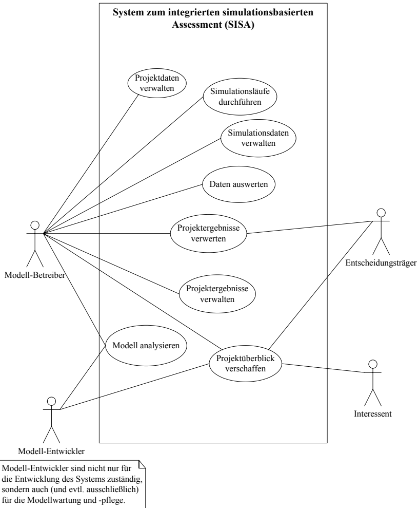
Abbildung 4.3: Anwendungsfalldiagramm des SISA. Zu sehen sind die einzelnen Nutzer des Systems (die Akteure) und die einzelnen Anwendungsfälle, für die das System Funktionen bereitzustellen hat. Der Modell-Betreiber nutzt das SISA zur Verwaltung von Projektdaten, Simulationsdaten und Projektergebnissen sowie zur Durchführung von Simulationsläufen und der Analyse der vorhandenen Daten. Die Projektergebnisse werden dem Modell-Betreiber und dem Entscheidungsträger vom System zur Verwertung bereitgestellt. Die Funktionen zur Analyse des Modells werden vom Modell-Betreiber und/oder vom Modell-Entwickler verwendet. Allgemeine (Hintergrund-)Informationen sind allen Akteuren (inkl. allgemeiner 'Interessenten') vom System bereitzustellen. Ausführlichere Angaben zu den Zielen und Funktionen finden sich im Text.
