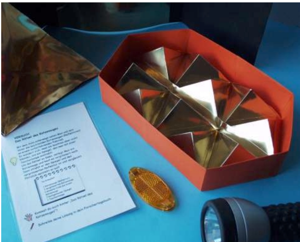
Abb. 2: Modell zur Funktion eines Reflektors
