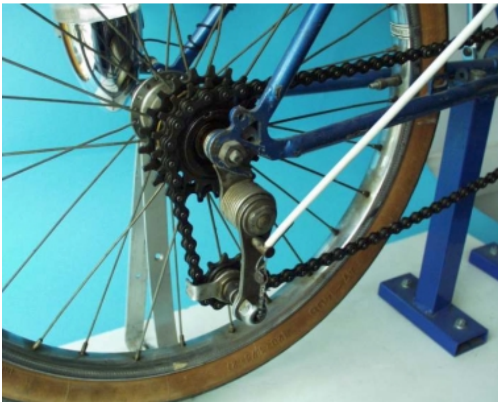
Abb. 3: Am Fahrradteilmodell kann die Kettenschaltung und die Funktion des Kettenwerfers untersucht werden
