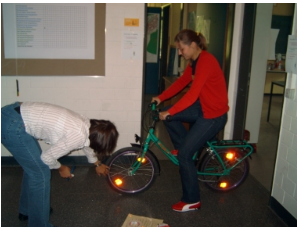
Abb. 9: "Wie weit fährt Puky?" Zwei Teilnehmerinnen beim Ausmessen der zurückgelegten Strecke bei einer Pedalumkehrung in verschiedenen Gängen
