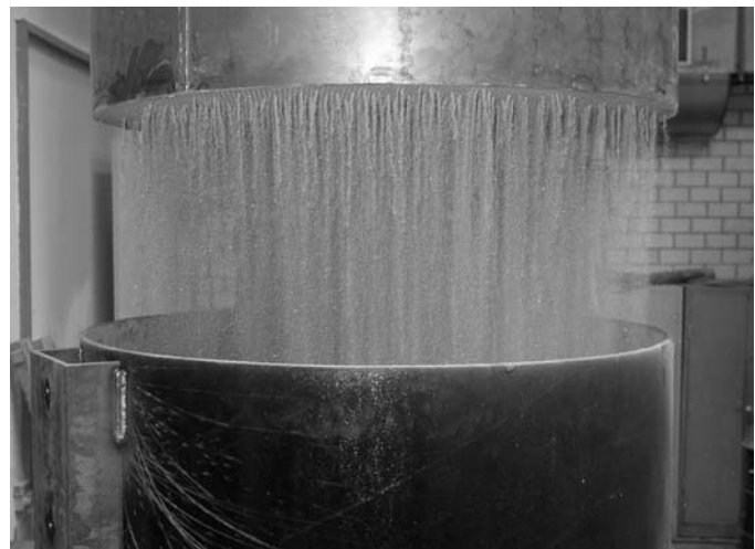
Bild 5.4: Die Rieselanlage (links) erzeugt einen flächenhaften Sandregen (rechts) zum definierten Sandeinbau
