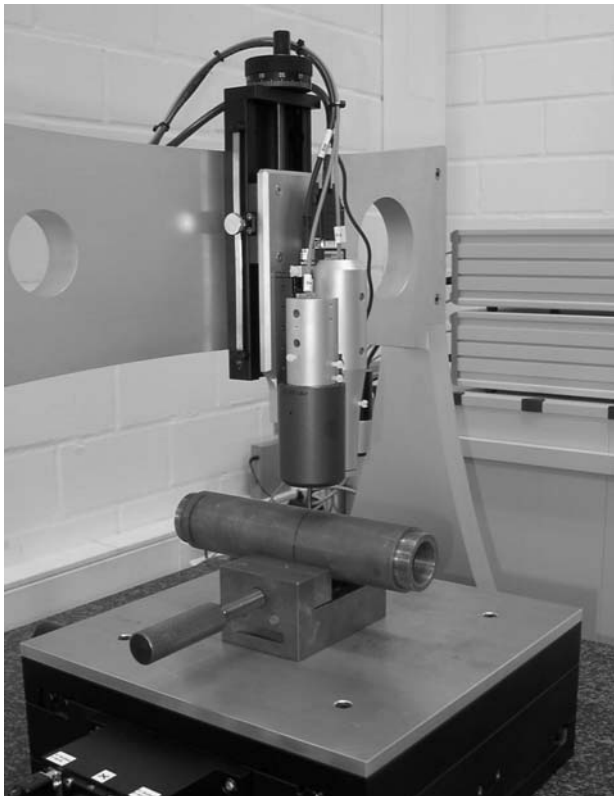
Bild 6.4: Optisches 3D-Messgerät zur Bestimmung der Oberflächenrauigkeit
