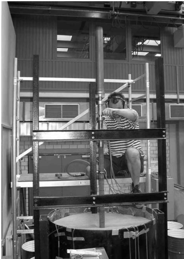
Bild 5.9: Rammung des besandeten Modellpfahls mit der mittelschweren pneumatischen Rammsonde
