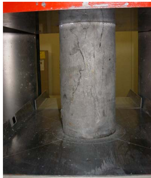
Abbildung 3.5-5: Prüfzylinder mit 2,5 Vol.-% Stahlfasern
