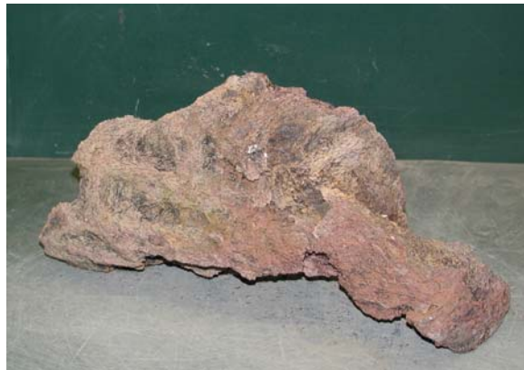
Abbildung 3.7-18: Probekörper M1 Q (4 Vol.-% Stahlfasern) nach Beflammung (ETK 90 Minuten)
