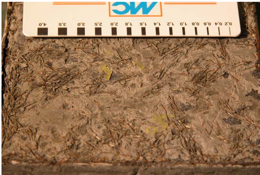
Abbildung 3.7-15: Detailaufnahme Befrostungsfläche; Grobkornbeton B3Q gefasert; Bildbreite 9 cm
