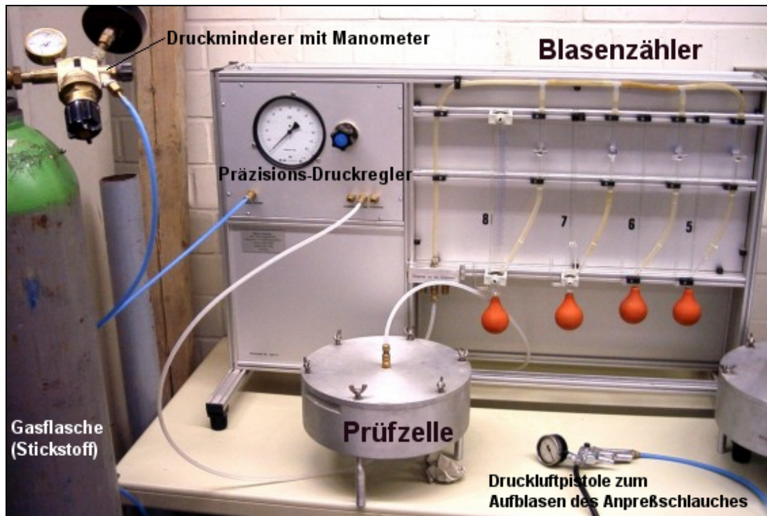
Abbildung 3.5-26: Prüfeinrichtung zur Ermittlung der Gaspermeabilität
