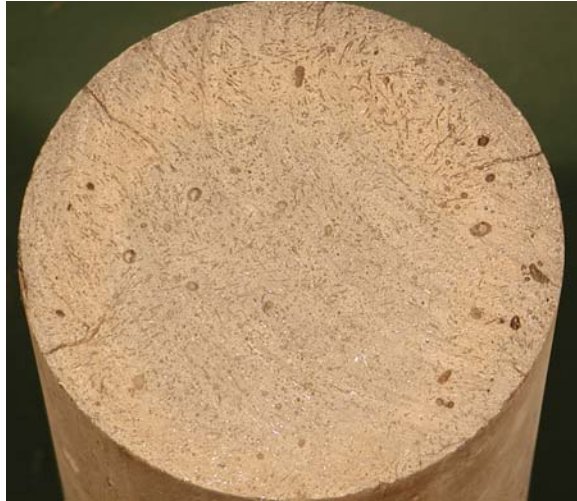
Abbildung 3.7-20: Probekörper M3 Q nach Beflammung (ETK 45 Minuten, 2,5 Vol.-% Stahlfasern, 0,6 Vol.-% PP-Fasern)
