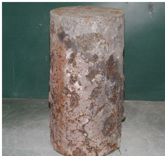
Abbildung 3.7-19: Probekörper B1 Q (4 Vol.-% Stahlfasern) nach Beflammung (ETK 90 Minuten)
