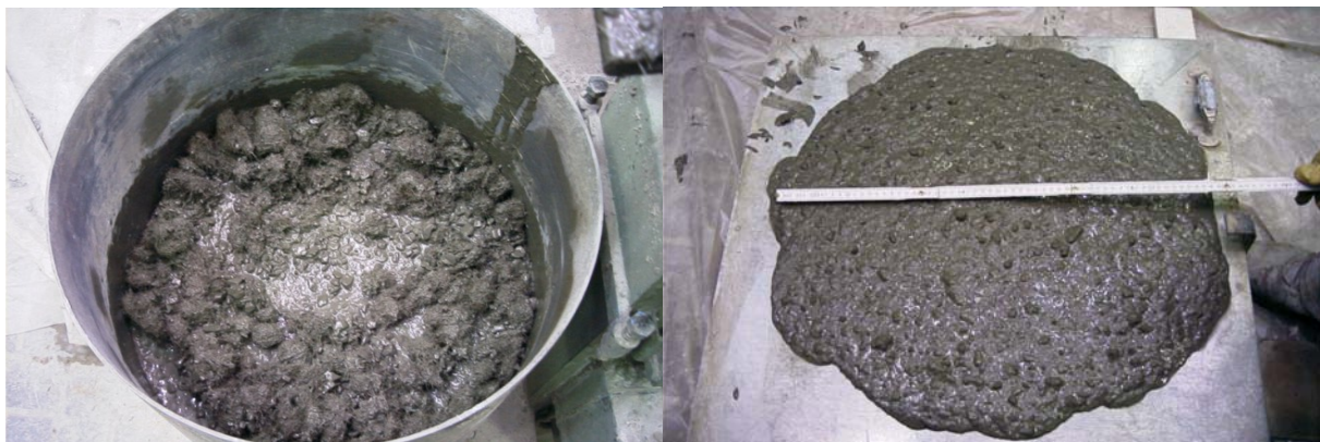
Abbildung 3.3-2: Konsistenz des Grobkornbetons B3Q mit 12 mm (links) und 6 mm (rechts) langen Stahlfasern ( \varnothing = 0,15 mm) nach 2 Minuten
