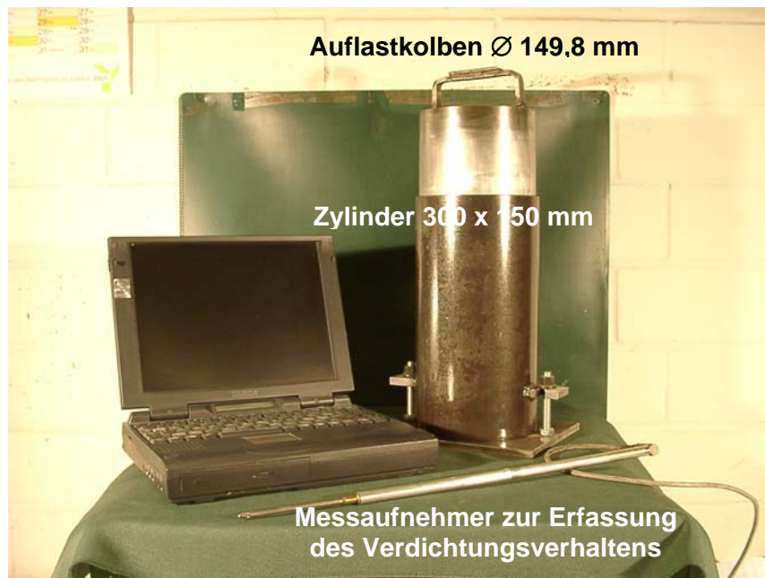
Bild 26: Rüttelproctor mit Laptop und Messaufnehmer zur Erfassung des Verdichtungsverhaltens
