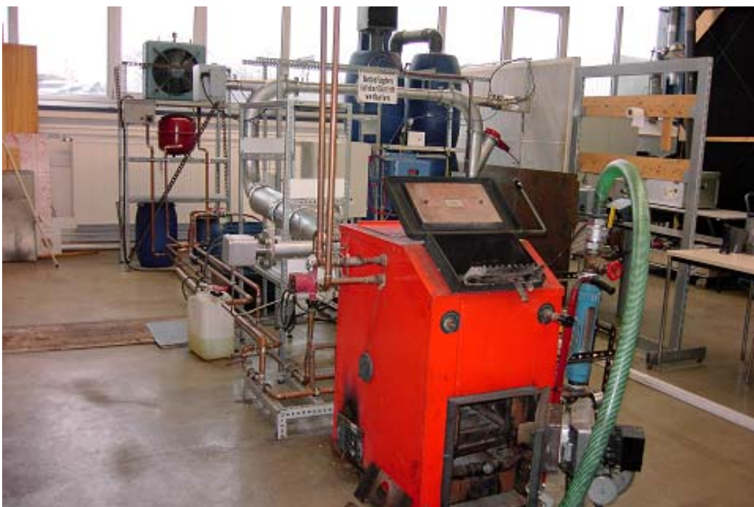
Abbildung 12 Feststoffkessel mit Primärluftzufuhr im Vordergrund
