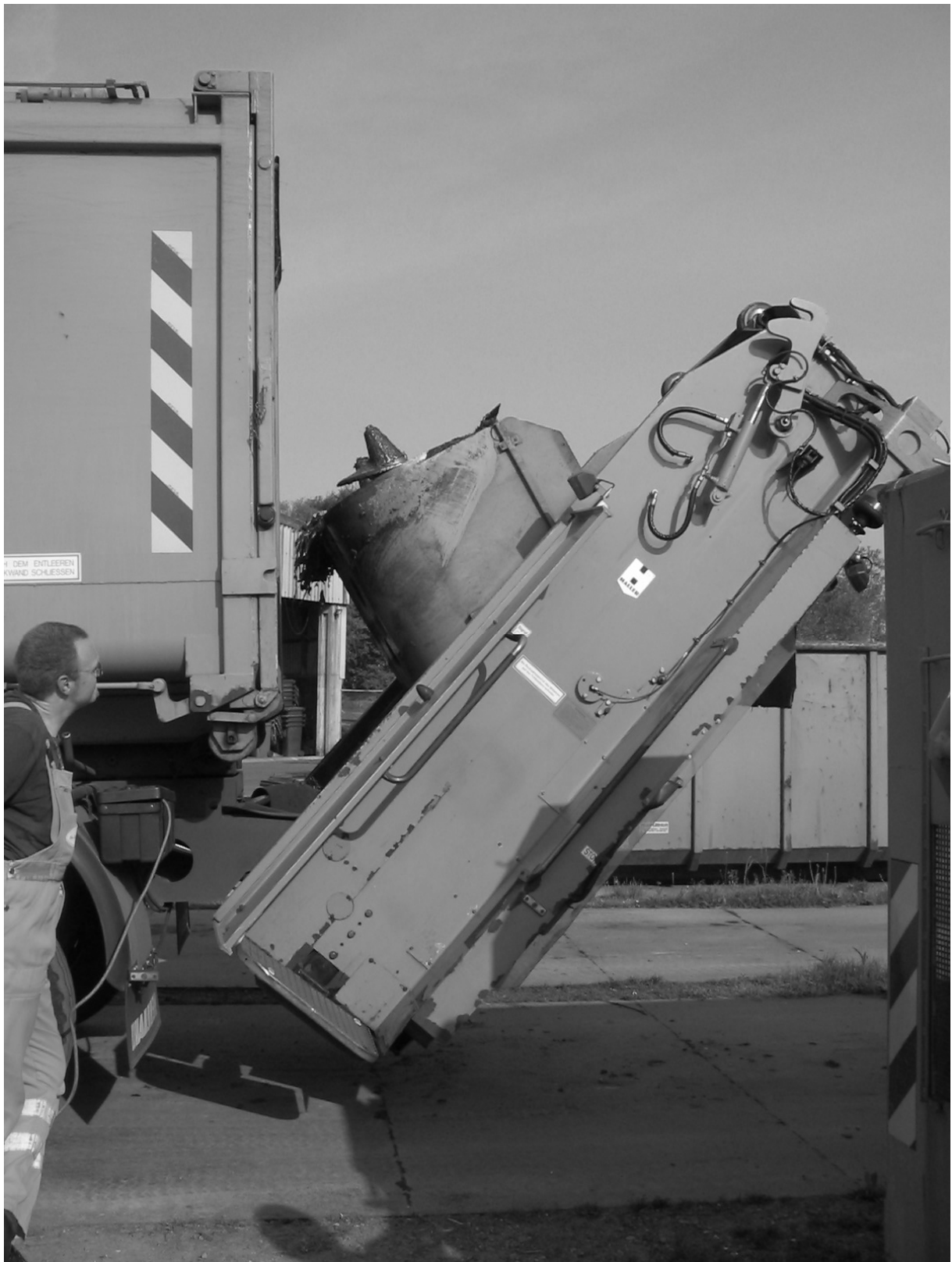
Abbildung 5: Abklappvorgang Schütte im LoToS-System
