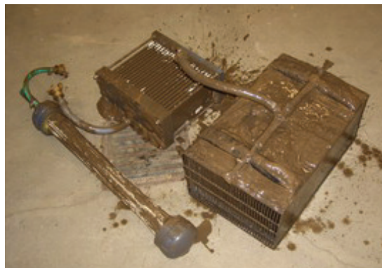
Abbildung 20: Membranen nach 3,5 Tagen Versuchsbetrieb, Versuchsstand 2
