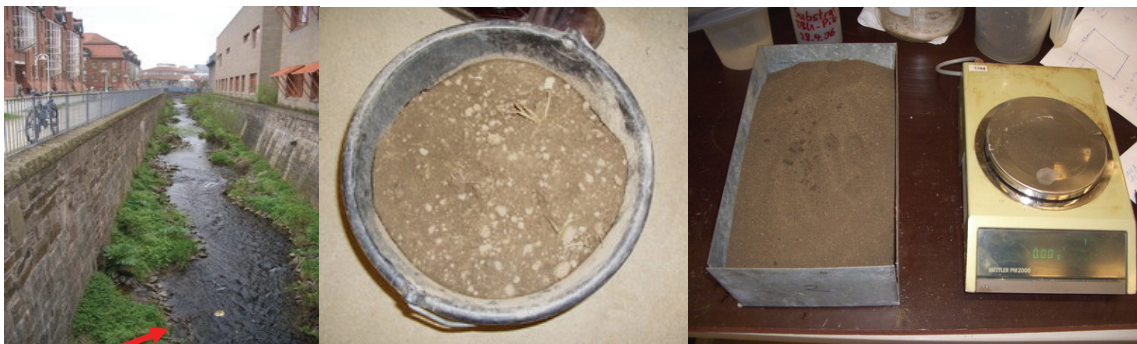
Abbildung 10: Bach „Ahna“ auf dem Gelände der Universität Kassel, Schlämmkorn aus der Ahna, gesiebtetes Schlämmkorn für die Versuchsdurchführung
