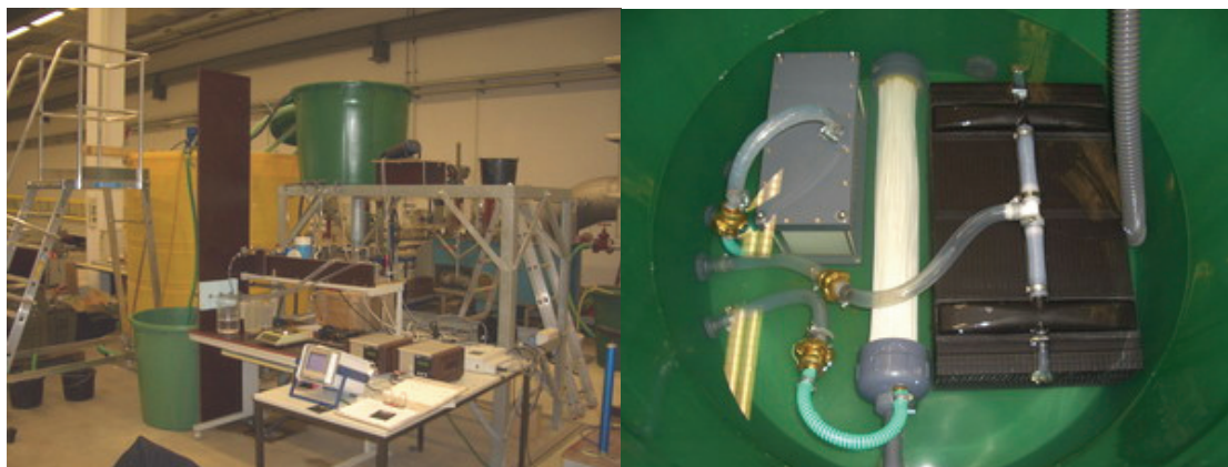
Abbildung 17: Ansicht Versuchsstand 2 (li.) und Beispiel für die Anordnung der Membranmodule im Filtrationsbehälter (re.)
