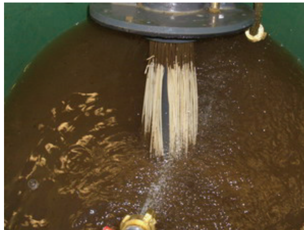
Abbildung 14: Membranreinigung nach 6 Tagen Versuchsbetrieb, Versuchsstand 1
