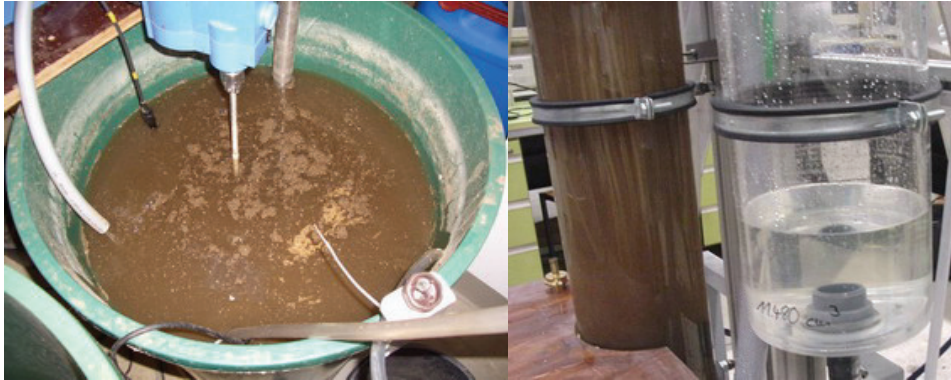
Abbildung 11: Konditioniertes Rohwasser, Filtrations- und Permeatsammelbehälter der Versuchsanlage 1
