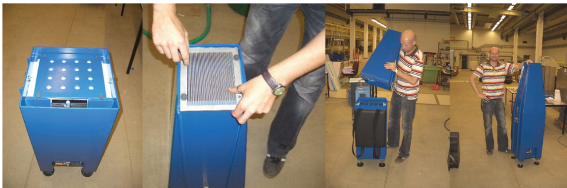
Abbildung 38: Einbau Membranabdeckung, Vorsieb, Aufsatz Gehäuseoberteil
