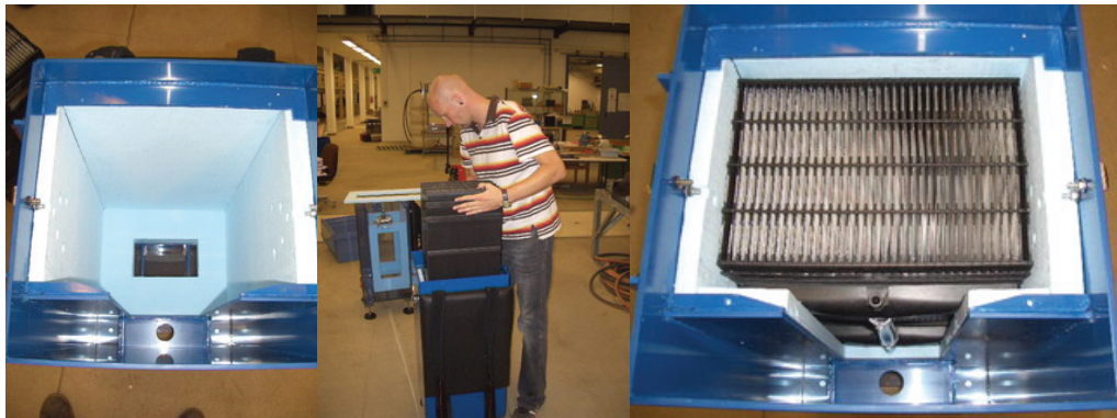
Abbildung 36: Einsetzen von Membrandämpfung und Membranmodul
