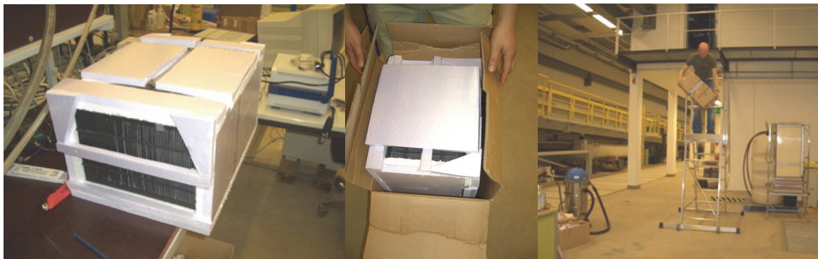
Abbildung 25: gedämmte Membran, Fallversuch aus 2 m Höhe
