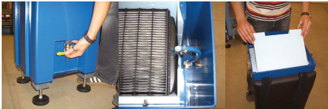
Abbildung 37: Einbau Permeathahn, Permeatleitung und obere Membrandämpfung
