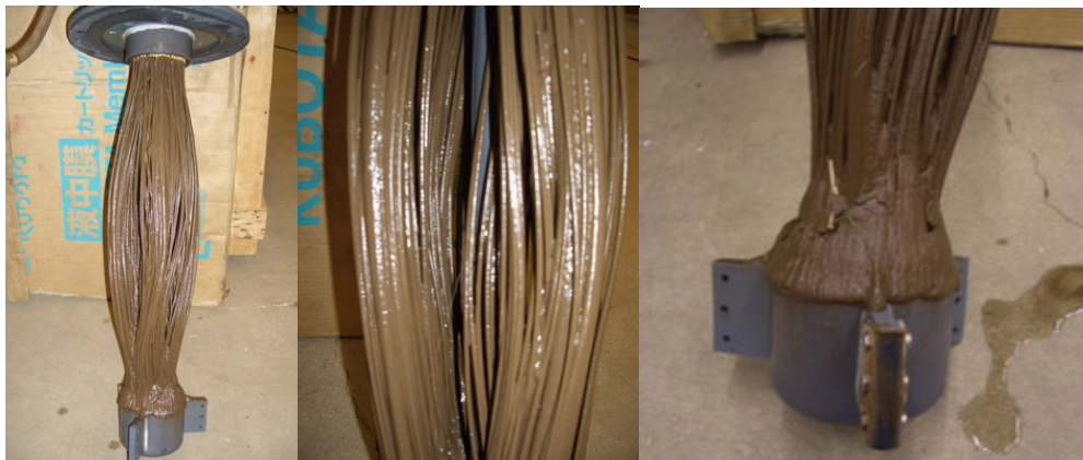
Abbildung 13: Membran nach 6 Tagen Versuchsbetrieb, Versuchsstand 1
