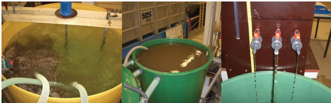
Abbildung 18: Vorlage- und Filtrationsbehälter, Permeatabläufe Versuchsstand 2
