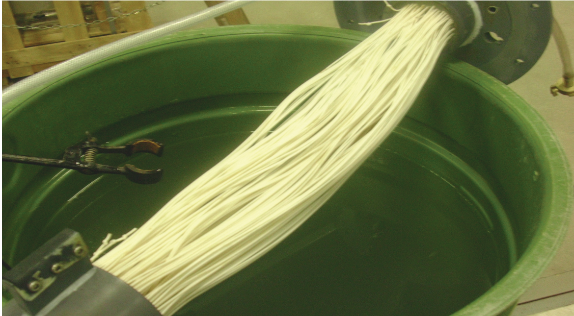
Abbildung 7: Membranmodul nach chemischer und mechanischer Reinigung, ANK KS Juni 2005
