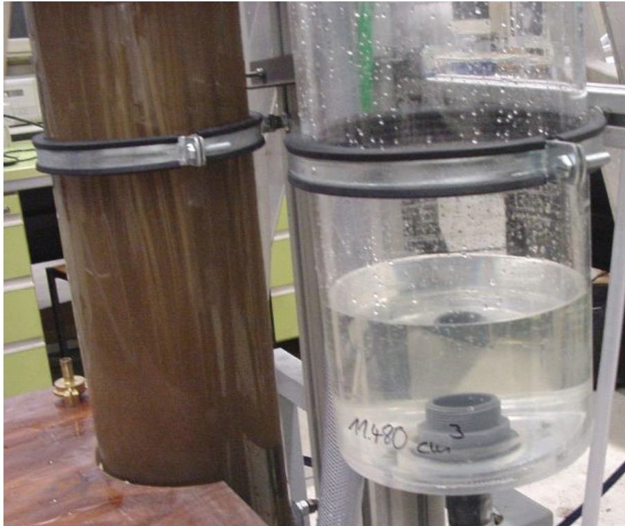
Abbildung 2: Membranbehälter der Versuchsanlage mit Hohlfasermembran, gefüllt mit Flusswasser und Sammelbehälter für das Permeat
