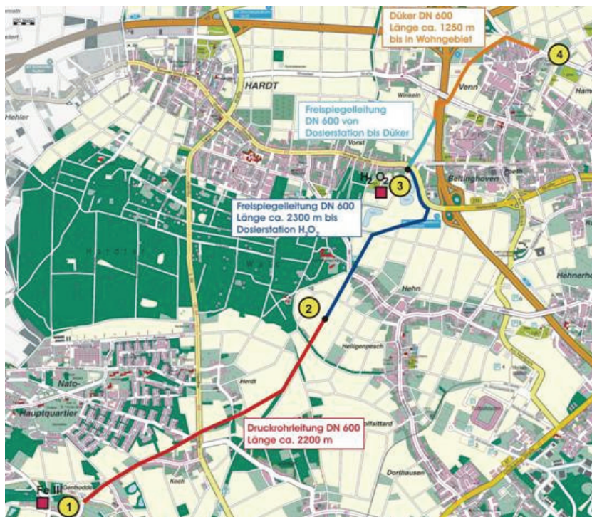
Abbildung 5.1: Messpunkte an der Kanaltteststrecke in Mönchengladbach- Genhodder (aus MUNLV NRW, 2005; Quelle Kartenhinter- grund: Stadt Mönchengladbach, Fachbereich Vermessung und Kataster, Geodatenzentrum)
