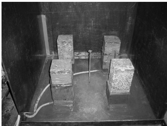
Bild B.2: Pfahlkraftmessungen und Setzungspegel (links) sowie Setzungsmessuhren unterhalb des Versuchsstandes (rechts) für Modellversuchsstand M1
