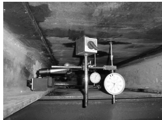
Bild B.2: Pfahlkraftmessungen und Setzungspegel (links) sowie Setzungsmessuhren unterhalb des Versuchsstandes (rechts) für Modellversuchsstand M1
