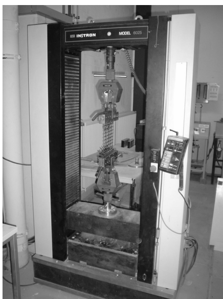
Bild 4.7: Versuchsstände zur Bestimmung der Zugfestigkeit (links) und des Herausziehwi- derstands (rechts)
