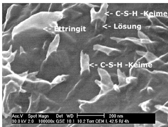
Abb. 3: Hochoffgelöste Abbildung im ESEM-WET Modus, C-S-H Keimbildungsprozess, Ettringit und Porenlösung auf der Klinkerkornoberfläche(vgl. Abb. 2)
