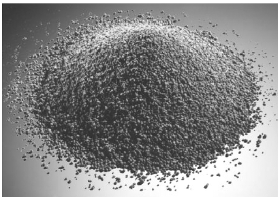
Bild 15: Mit einem PCM getränktes Granulat [12]
