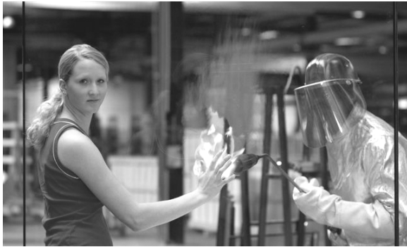
Abb. 3: Brandschutzgele auf Basis modifizierter \text{SiO}_2 -Nanopartikel verbessern die Feuerfestigkeit von Verglasungen deutlich. Im Brandfall bildet sich ein formstabiler Schaum aus, der nicht von der Glasoberfläche abfließt (Bild rechts) (Quelle INM, Saarbrücken)
