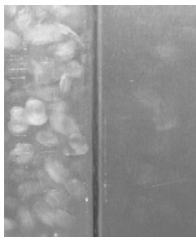
Abb. 4: Transparente Antifingerprint-Beschichtungen auf Basis funktionalisierter Siliziumdioxid-Nanopartikel für Edelstahloberflächen und –armaturen (Foto Sylvia Leyendecker).
