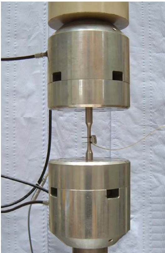
Abb. 6.6: Eingespannter Probekörper mit Axial-Extensometer
