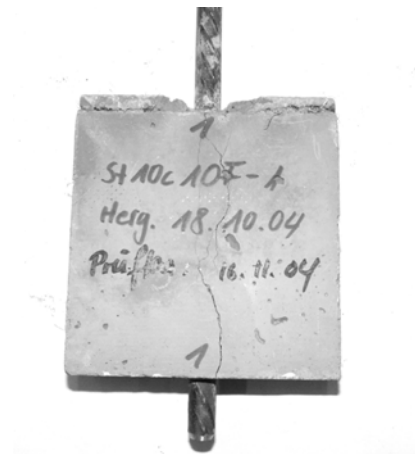
Bild 3.20 Längsrissbildung bei reduzierter Betondeckung (hier: c = 1,0 d_s )
