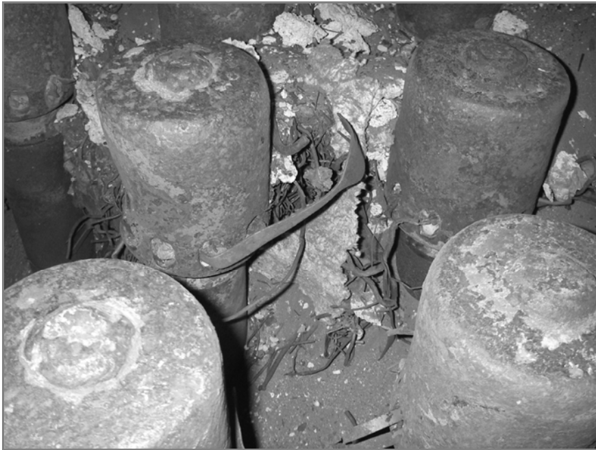
Abbildung 7: Düsen nach 4000 Stunden Betrieb mit Verstopfungen
