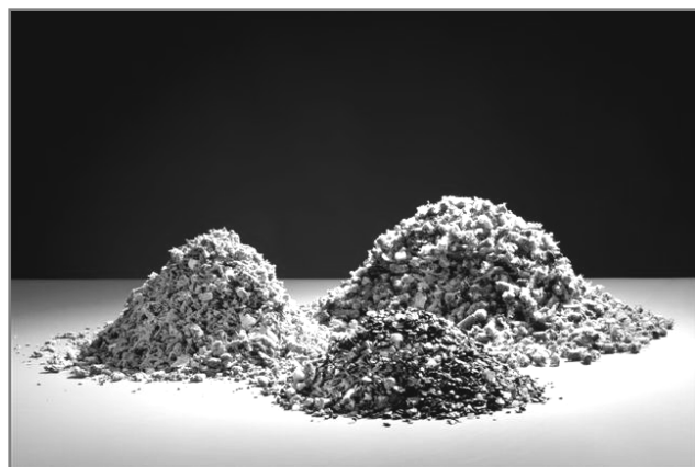
Abbildung 3: Kunststofffraktionen als Reduktionsmittel im Hochofenprozess
