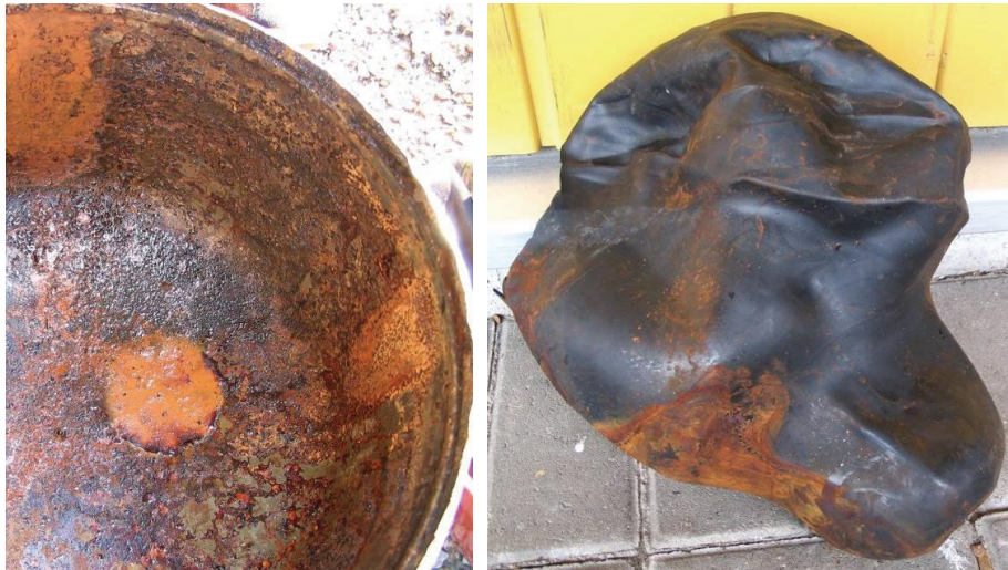
Abbildung 3.31: Links: Starke Rostbildung im Innern eines MAG der Anlage VRK1. Rechts: „Ausgebeulte“ Ballonmembran.
