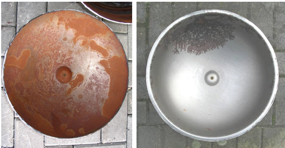
Abbildung 3.32: Zwei baugleiche MAG in unterschiedlich gutem Zustand (links: MAG der Anlage FK2; rechts: MAG der Anlage B-LA).
