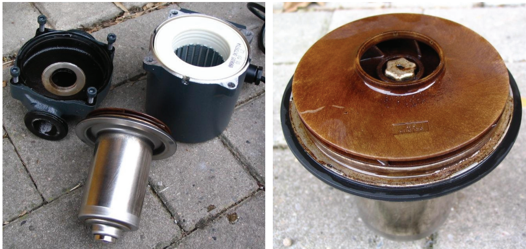
Abbildung 3.35: Gehäuse, Rotor, Stator und Spirallaufrad der Pumpe.
