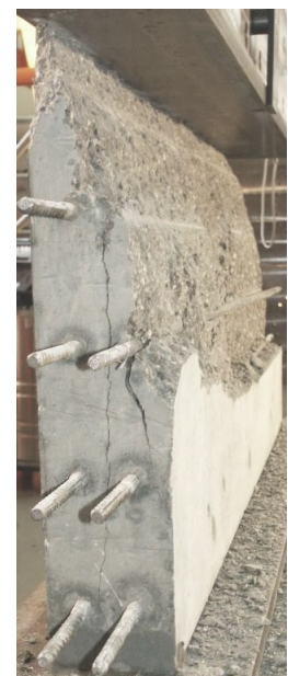
d) Bruchbild einer Scheibe ohne vertikale Bewehrung d) failure of a panel without vertical reinforcement
