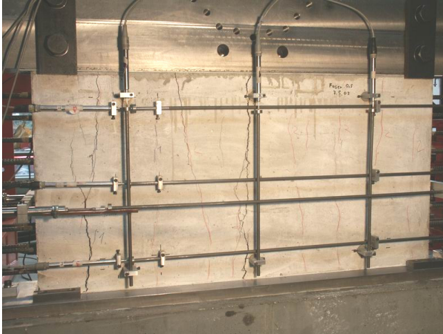
Bild A.1-70. Rissbild der Scheibe F075T (Ansicht Nord) Fig. A.1-70. Crack pattern of Panel F075T (view north)
