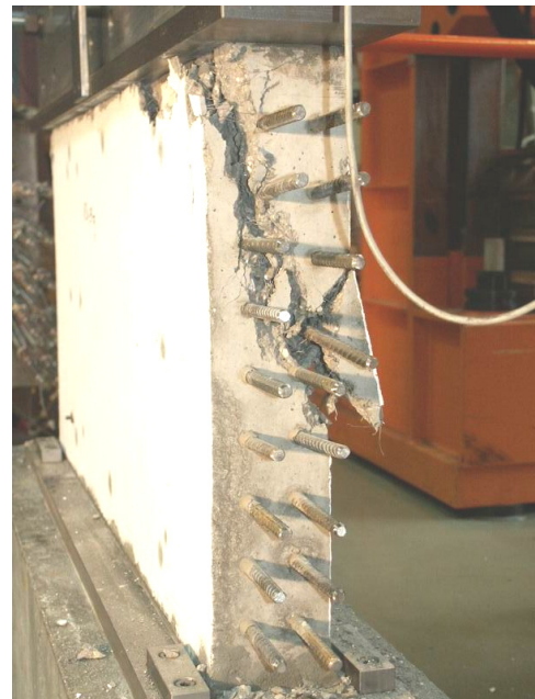
Bild A.4-60. Bruchbild der Scheibe F000VK4 (Ansicht West) Fig. A.4-60. Panel F000VK4 at failure (view west)
