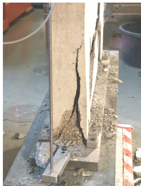
Bild A.2-13. Bruchbild der Scheibe VK3 (Ansicht Ost) Fig. A.2-13. Panel VK3 at failure (view east)
