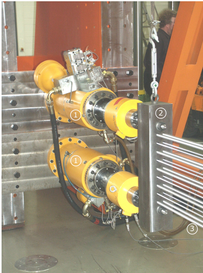
Bild 5-5. Einleitung der Zugkräfte: Zugzylinder mit Querhaupt und Zugstangen (links) und Scheibe mit Zugstangen und Kraftmesszellen (rechts)
