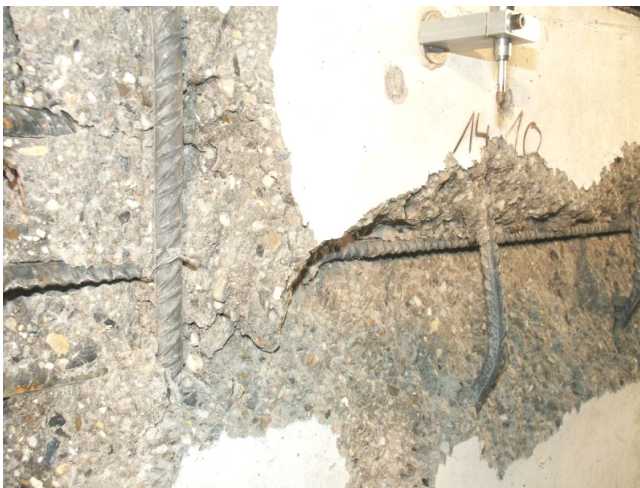
Bild A.2-26. Bruchbild der Scheibe 000VK2 (Ansicht Nord) Fig. A.2-26. Panel 000VK2 at failure (view north)
