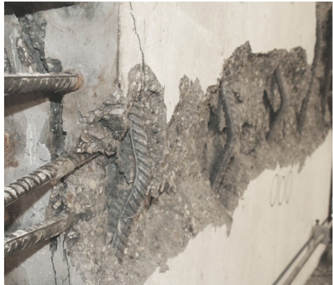
b) Ausknicken der vertikalen Querbewehrung, verbunden mit einem Absprengen der Betondeckung b) buckling of the vertical reinforcement combined with spalling of the concrete cover
