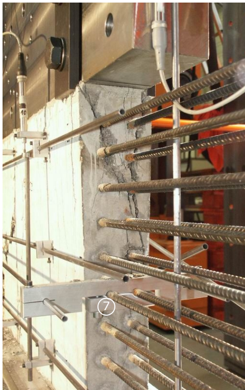
Bild 5-10. Anordnung der Messvorrichtungen zur Erfassung der Verformungen der Scheibe und für die Steuerung der Hydraulikzylinder
