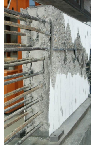
a) Ausknicken der vertikalen Querbewehrung und Absprengen der Betondeckung (Scheibe 025VK) a) buckling of the vertical reinforcement and spalling of the concrete cover (Panel 025VK)
