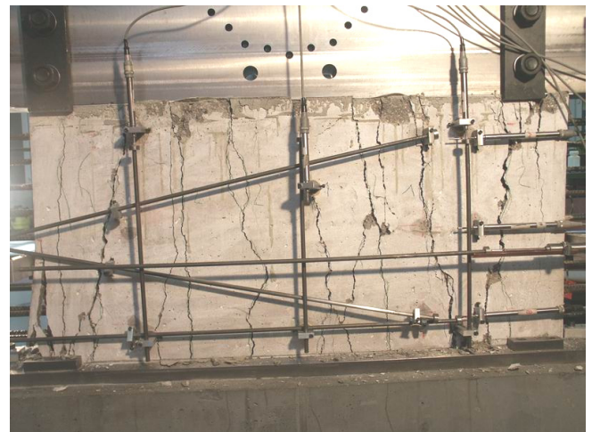
Bild A.1-41. Bruchbild der Scheibe 250T (Ansicht Süd) Fig. A.1-41. Panel 250T at failure (view south)
