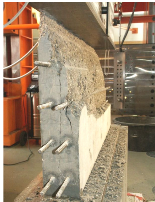
Bild A.2-124. Bruchbild der Scheibe Q000VK (Ansicht Ost) Fig. A.2-124. Panel Q000VK at failure (view east)
