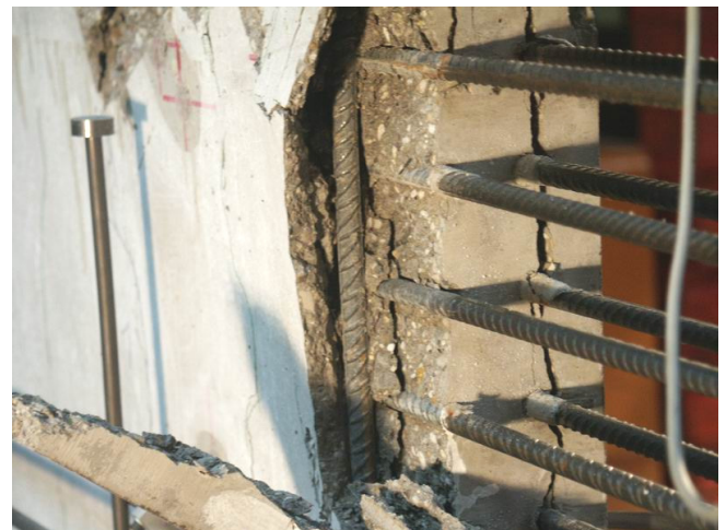
Bild A.1-33. Bruchbild der Scheibe 075T (Ansicht Nordwest) Fig. A.1-33. Panel 075T at failure (view north-west)
