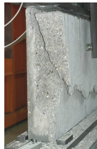
b) Schubbruch der quervorgedehnten, faserverstärkten Stahlbetonscheibe F025VK b) shear failure of the transversely pre-stressed reinforced steel fibre concrete Panel F025VK
