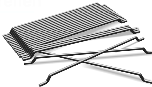
Bild 4-3. Zu Streifen verleiimte, hochfeste Dramix®-Stahlfasern mit gekröpften Enden der Fa. Bekaert Deutschland GmbH
