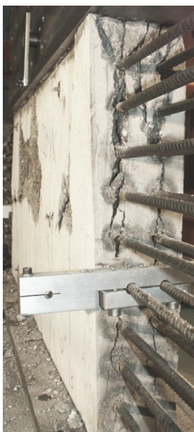
Bild 6-7. Typische Bruchbilder der Beton- und Stahlbetonscheiben der Serie 2 Fig. 6-7. Typical failure patterns of concrete and reinforced concrete panels of Series 2
