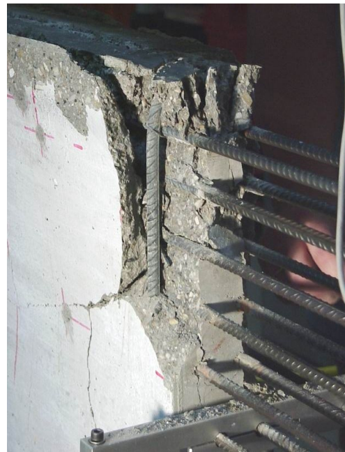
Bild A.1-3. Bruchbild der Scheibe 000T (Ansicht Ost) Fig. A.1-3. Panel 000T at failure (view east)
