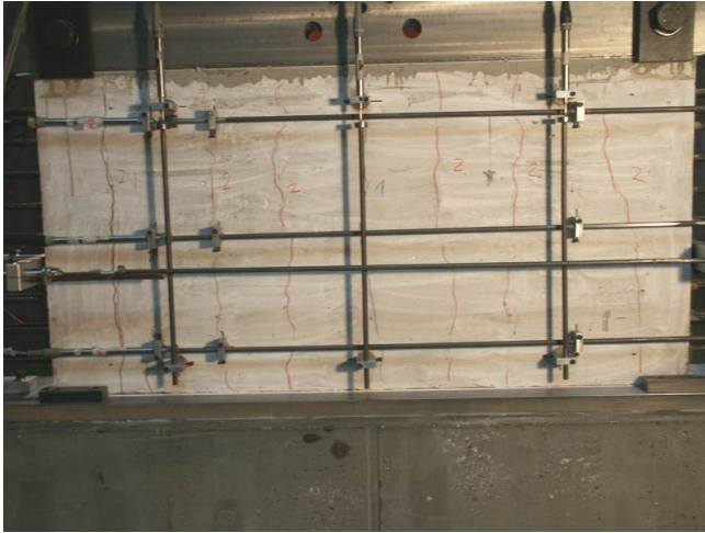
Bild A.1-14. Rissbild der Scheibe 025T (Ansicht Nord) Fig. A.1-14. Crack pattern of Panel 025T (view north)
