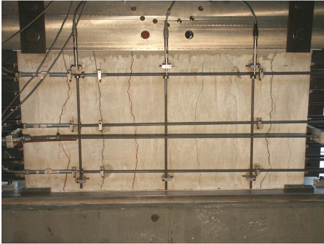
Bild A.1-30. Rissbild der Scheibe 075T (Ansicht Nord) Fig. A.1-30. Crack pattern of Panel 075T (view north)
