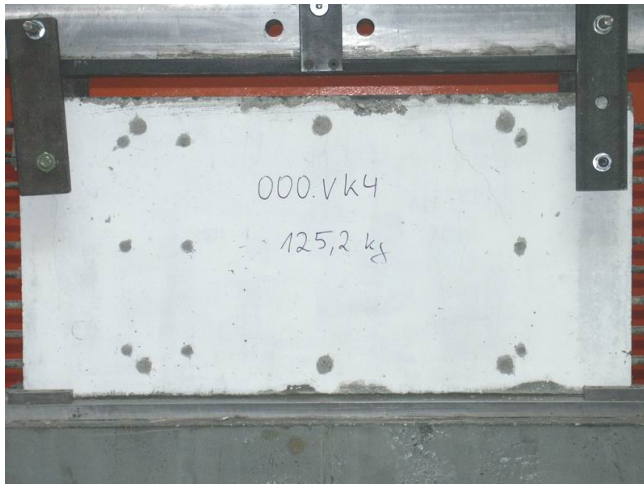
Bild A.4-9. Bruchbild der Scheibe 000VK4 (Ansicht Nord) Fig. A.4-9. Panel 000VK4 at failure (view north)
