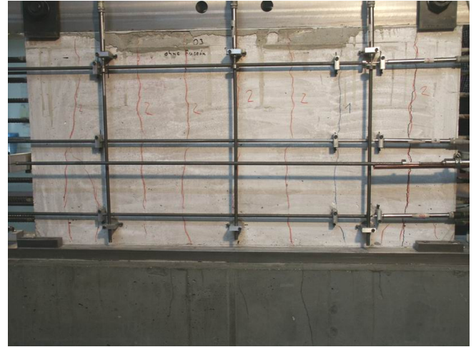
Bild A.1-15. Rissbild der Scheibe 025T (Ansicht Süd) Fig. A.1-15. Crack pattern of Panel 025T (view south)
