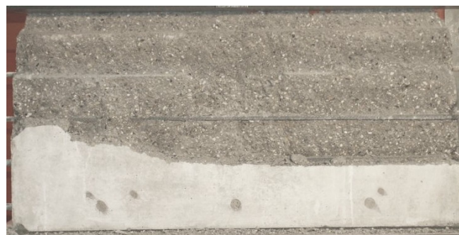
d) Bruchbild einer Scheibe ohne vertikale Bewehrung d) failure of a panel without vertical reinforcement
