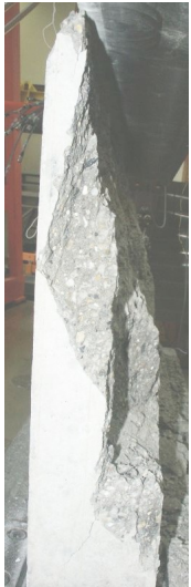
a) Schubbruch einer unbewehrten Betonscheibe a) shear failure of an unreinforced concrete panel
