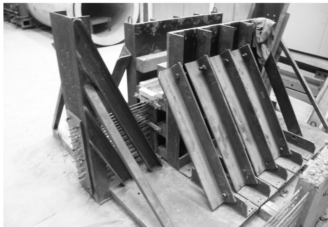
Bild 3-2. Schalung der Versuchsscheiben
