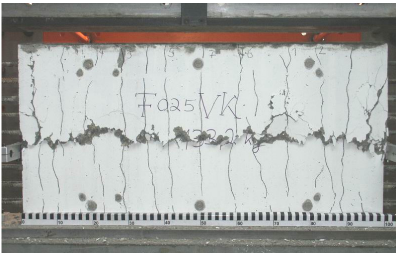
b) Schubbruch der quervorgedehnten, faserverstärkten Stahlbetonscheibe F025VK b) shear failure of the transversely pre-stressed reinforced steel fibre concrete Panel F025VK
