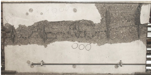
b) Ausknicken der vertikalen Querbewehrung, verbunden mit einem Absprengen der Betondeckung b) buckling of the vertical reinforcement combined with spalling of the concrete cover
