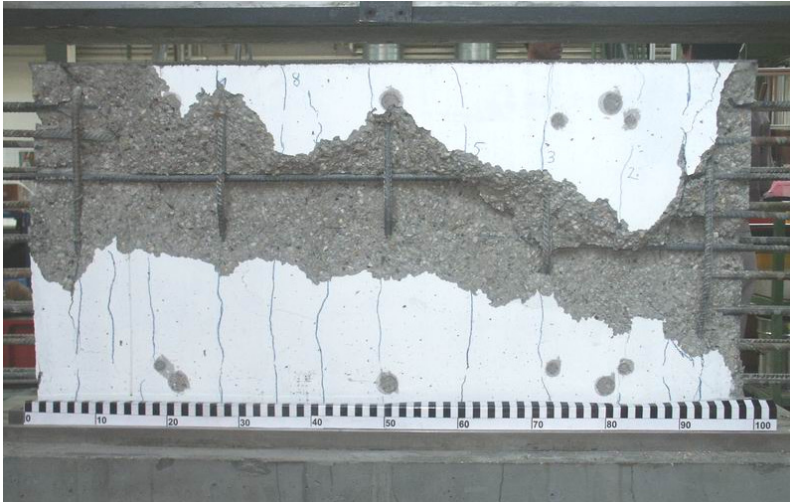
a) Ausknicken der vertikalen Querbewehrung und Absprengen der Betondeckung (Scheibe 025VK) a) buckling of the vertical reinforcement and spalling of the concrete cover (Panel 025VK)
