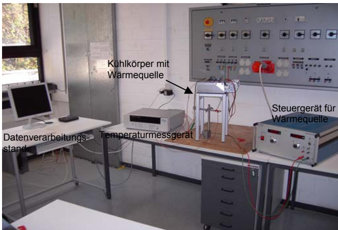
Bild 6.6: Messstand für die Temperaturmessung des Kühlsystems
