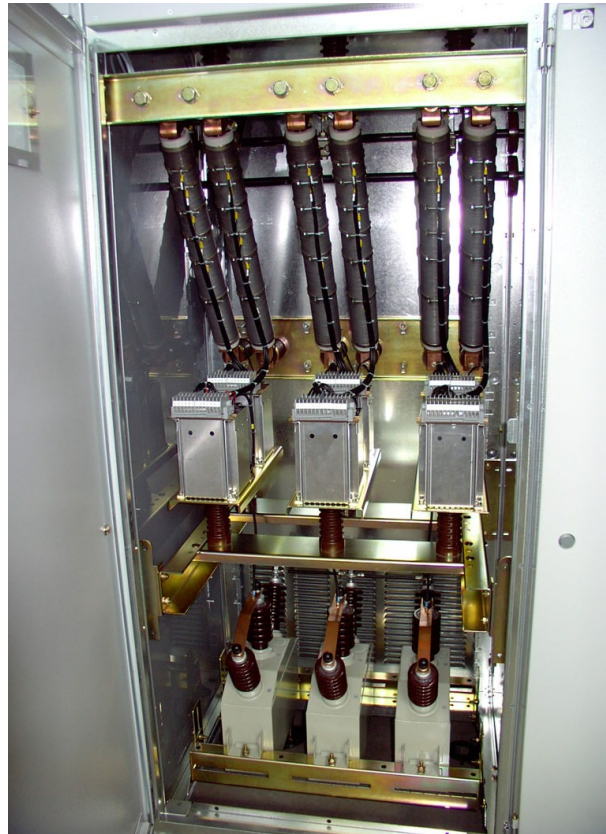
Bild 4.4: Leitungsnachbildung mit konzentrierten Bauelementen
