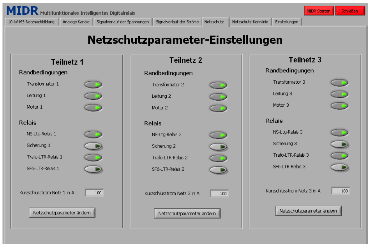
Bild 5.23: Bedienfeld für Einstellung der Randbedingungen und der Netzschutzparameter
