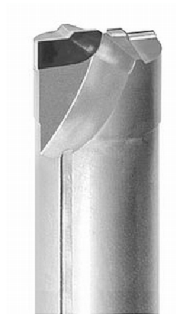
Abb. 2.9: Formfräser mit PKD – Schneide /118/
