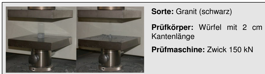
Abb. 4.28: schwarzer Granit beim einachsigen Druckversuch
