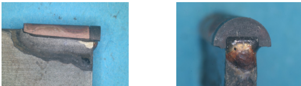
Abb. 5.3: halbrunde Elementform mit Nut
