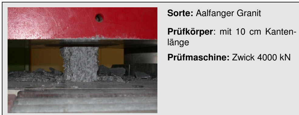
Abb. 4.27: Aalfanger Granit beim einachsigen Druckversuch
