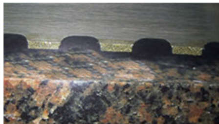
Abb. 2.5: galvanisch belegte Natursteinsäge /109/
