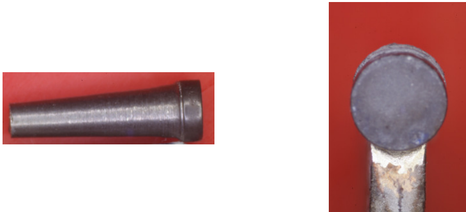
Abb. 5.2: Schneidkörper mit kreisförmiger Spanfläche
