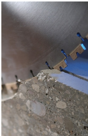
Abb. 2.7: Kreissägeblatt mit gesinterten Diamantsegmenten /109/
