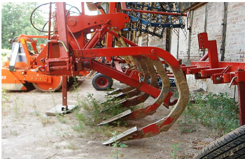
Abbildung 10: Tiefenlockerer nach Turiel zum Einsatz gegen Bodenverdichtungen (Brandt, 2003).
