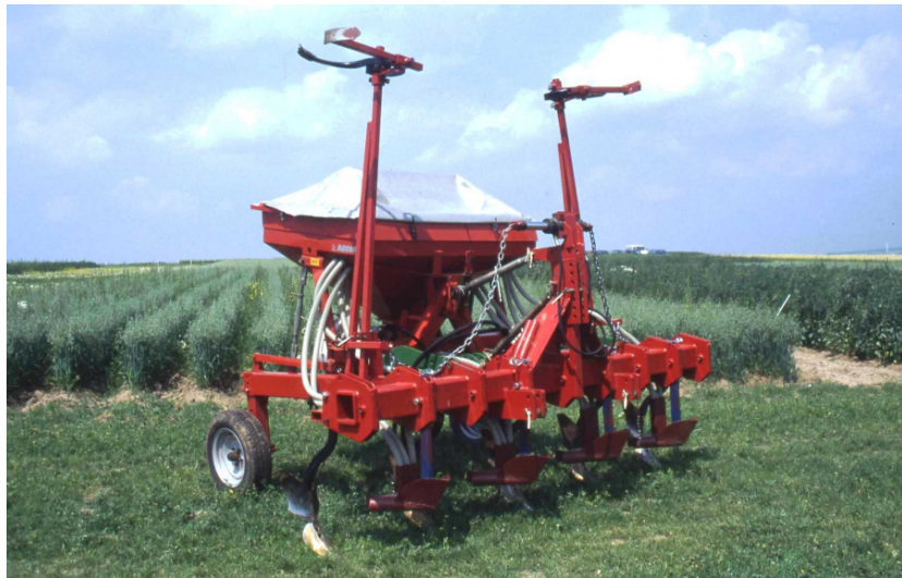
Abbildung 8b: Das Dammkulturgerät mit aufgesattelter pneumatischer Sämaschine (Wildhagen, 2003).
