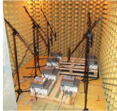
Abbildung 2.21: Schalllabor mit Leistungsschaltern
