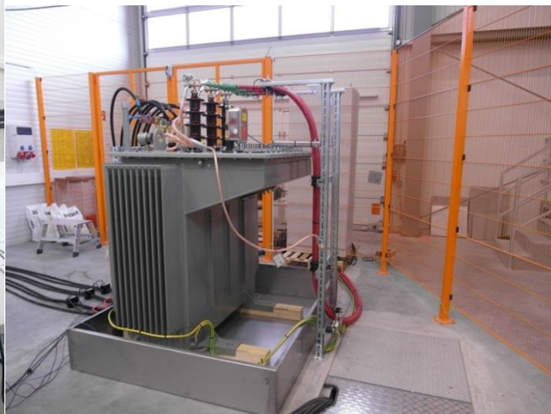
Abbildung 6.5: Echtzeitnetzsimulator , Leistungsverstärker (links) und RONT (rechts) in der SysTec des Fraunhofer IWES.
