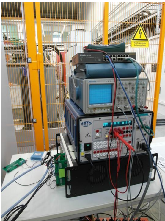
Abbildung 6.5: Echtzeitnetzsimulator , Leistungsverstärker (links) und RONT (rechts) in der SysTec des Fraunhofer IWES.
