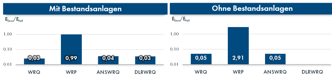
Abbildung 3.18: Zu erwartende Verluste durch Abregelung der Wirkleistung in Bezug auf die Einspeisung mit reiner Wirkleistung
