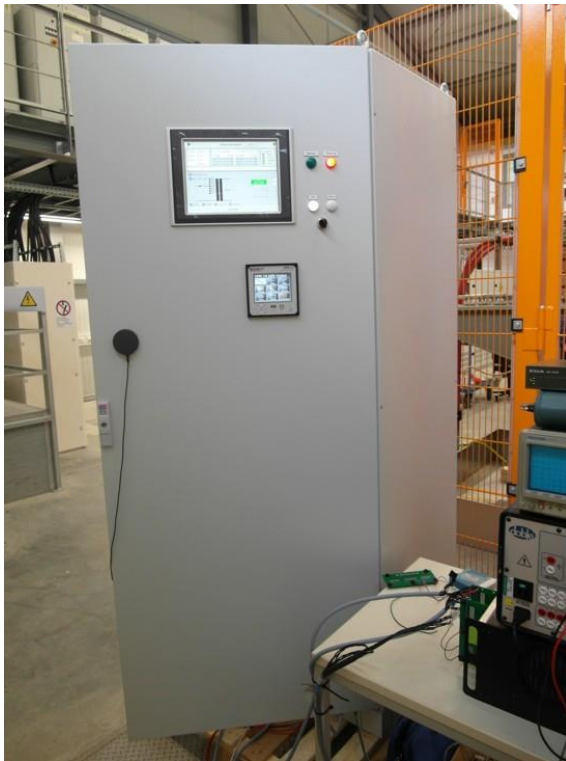
Abbildung 6.4: Schaltschrank mit Bedienoberfläche (links) und SPS mit der Regelungs- und Betriebsführung im Schaltschrank (rechts).
