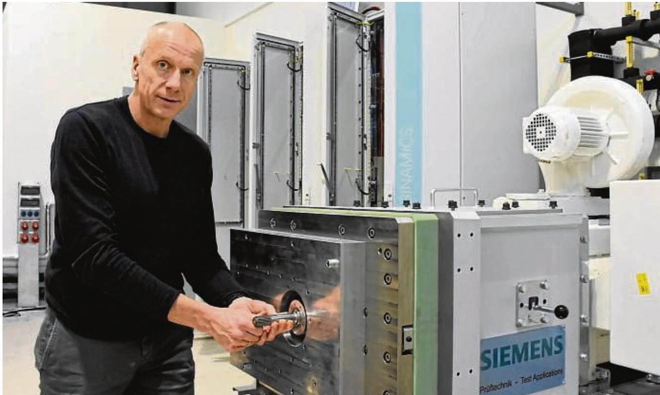
**Leistungstärkster Prüfstand im Fachgebiet:** Labormitarbeiter Thomas Waldmann setzt die Welle in die Lastmaschine des Prüfstands ein. Sie überträgt die Kraft auf die zu prüfenden Antriebe. In den Schränken im Hintergrund sind die Umrichter zu sehen, die den Prüfstand mit elektrischem Strom versorgen werden. Noch ist die Anlage nicht fertig montiert.
