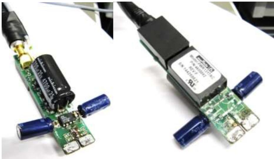
Abbildung 2.17: Am KDEE entwickelter Treiber für SiC-Halbleiter
