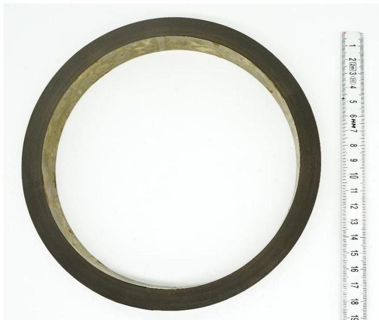
Abb. 49: Ringbandkern aus dem nanokristallinen Material VITROPERM 500 Z vor dem Bewickeln
