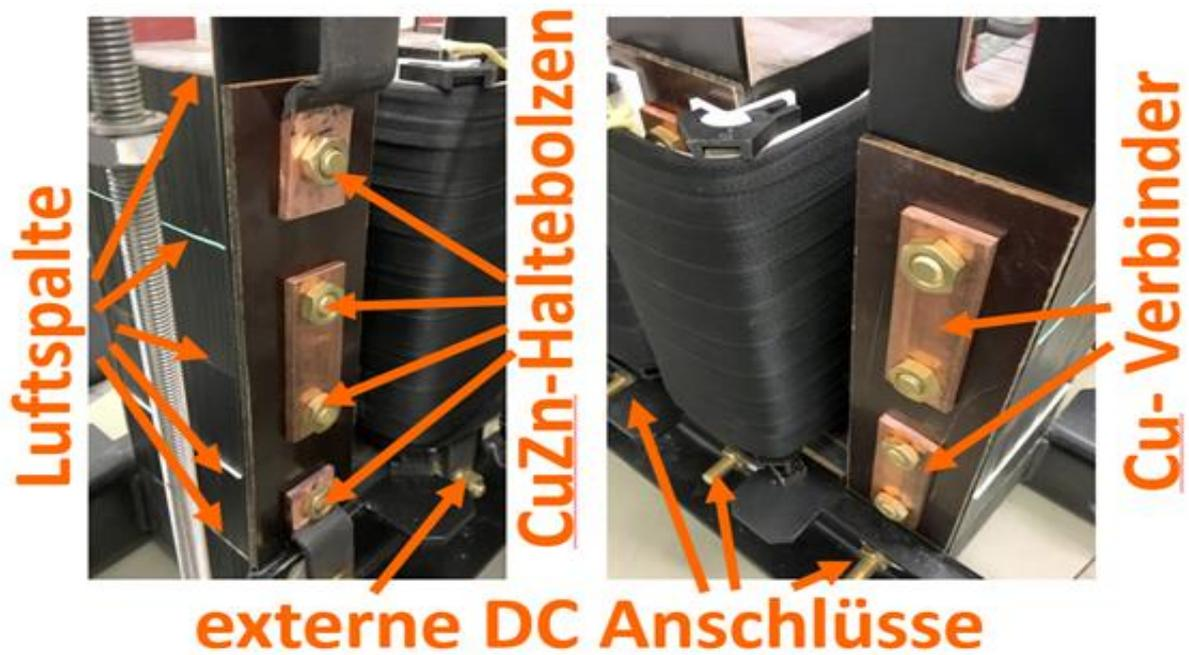
Abb. 42: Implementierung des VAG-Konzepts mit Hilfe der Haltebolzen zur mech. Befestigung der Blechpakete
