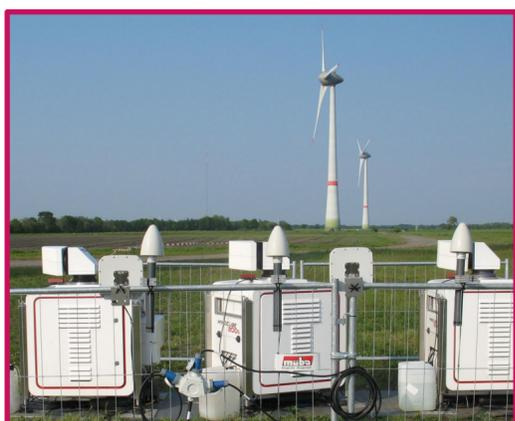
Einsatz der Lidar-Technik (light detection and ranging) zur Windmessung
