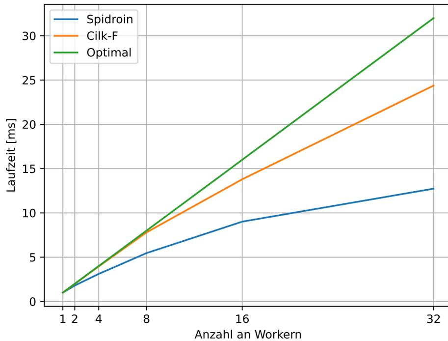
Abbildung 4.4: Speedup  $S_n = \frac{T_1}{T_n}$  mit 40 Zeitschritten, 10.000 Knoten und 40 Features
