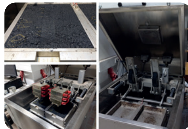
Verformungswiderstand von kunststoffmodifiziertem Asphalt im Laborversuch
