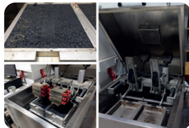
Verformungswiderstand von kunststoffmodifiziertem Asphalt im Laborversuch
