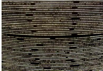
Detail: in den Beton eingelegte Lichtleitfasern
