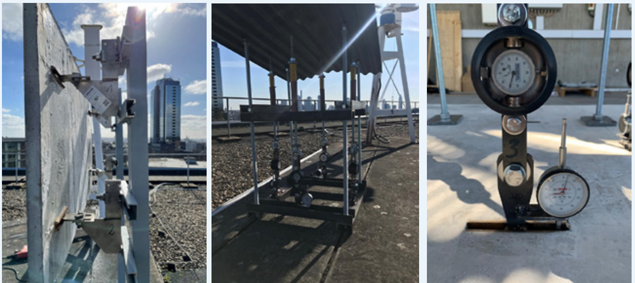
Bild 5: Langzeitversuche zur Dauerhaftigkeit des neuen Verbindungskonzeptes aus Memory-Stahl
