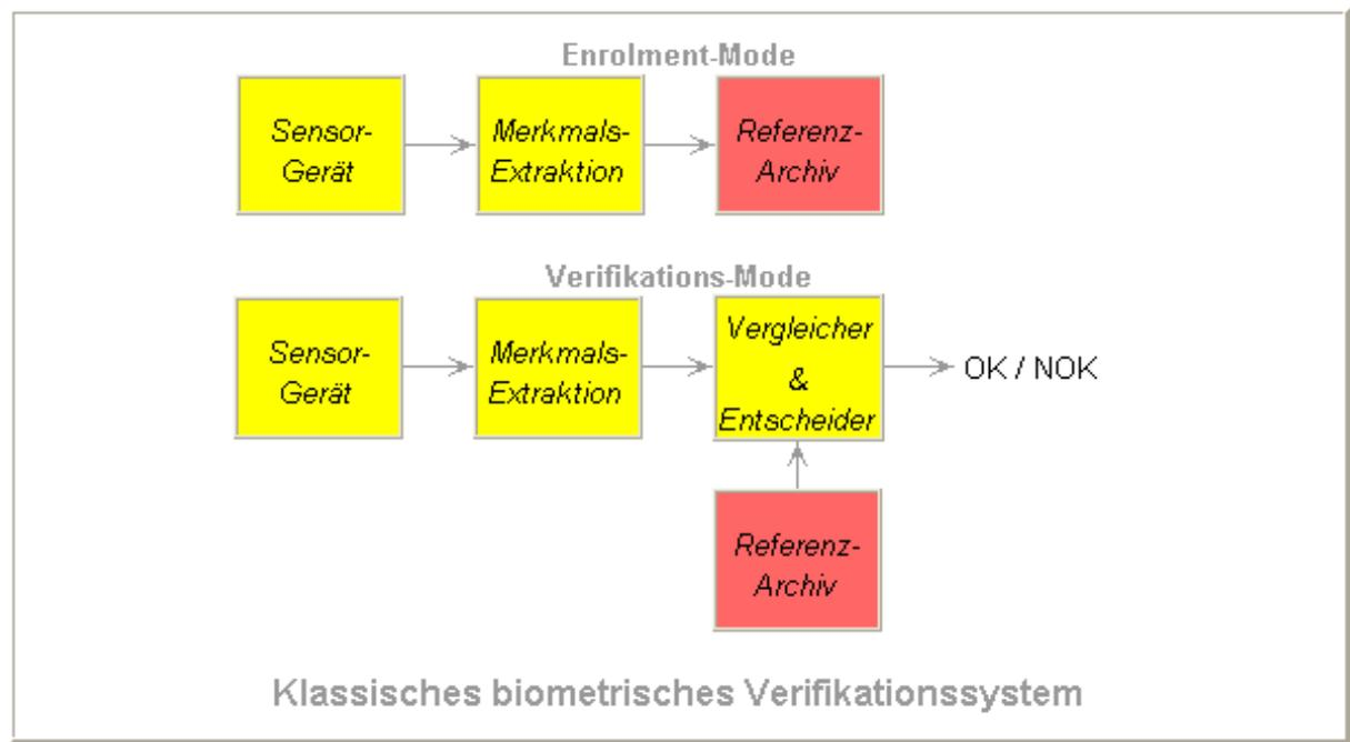
Damit ist es auch möglich, diese Blöcke an unterschiedlichen Orten zu betreiben, wobei die Gesamtfunktionsfähigkeit über die dazwischenliegenden Verbindungen gewährleistet ist. Diese Verbindungen können geräteintern sein oder über öffentliche oder private Netze führen. Sie lassen sich bei Bedarf mit bekannten kryptografischen Methoden schützen.
