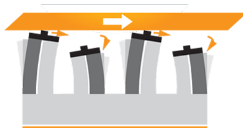
Abbildung 6.1: Schematische Darstellung der Aktoren. Zu sehen sind die vier Beine des Schrittmotors. Diese bestehen aus zwei Piezokeramiken und bilden somit die bimorphe Bauform. Die Lauffläche ist oben in gelb dargestellt. (Quelle: PiezoMotor, Technology, https://piezomotor.com/technology/ , letzter Aufruf 21.10.2020)
