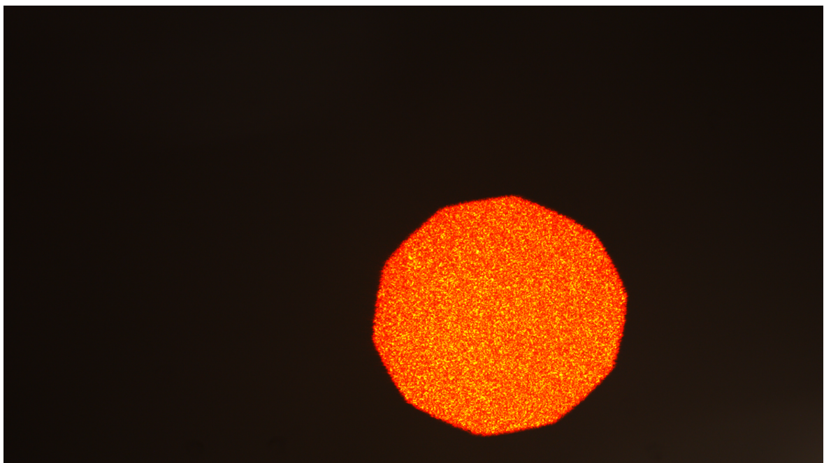
Abbildung 4.3: Das Licht des HeNe-Lasers wurde durch eine Diffuserplatte und ein Blatt Papier abgeschwächt. Nach dem Durchlaufen des Kollimators wird es mittels eines Teleskops betrachtet. Die Blende muss nun möglichst scharf auf der Kamera abgebildet werden.
