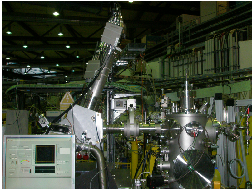
Abb. 5.6: Photo des neu aufgebauten Seya-Namioka-Spektrometers an der Targetkammer für Diamantoid-Messungen. Durch den größeren Öffnungswinkel kommt es zu keiner Kollision zwischen Kammer und Spektrometer, was sich auch bei weiteren Messungen als vorteilhaft erwies.
